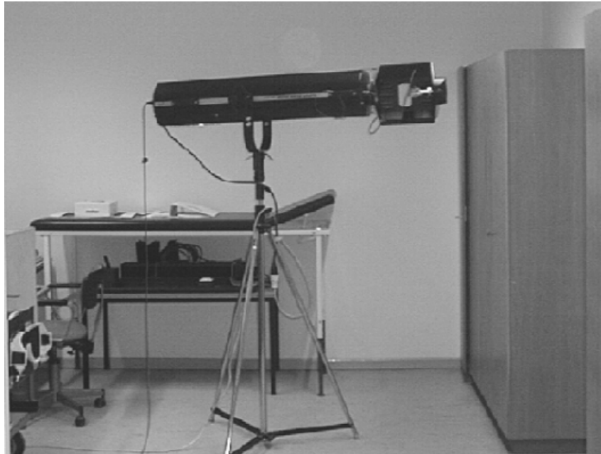
Abbildung 6.2.3.2/1: Der Scheinwerfer des Projektionssystems zur Simulation des periodischen Schattenwurfs.
